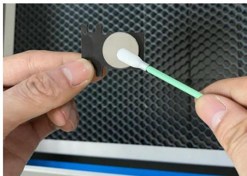
第一反射镜安装在激光管后箱中，打开后查看右侧
